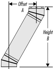
Ce tableau a trois colonnes pour déterminer l'angle de coude nécessaire afin d'atteindre la déviation requise. La première colonne (« A ») est la mesure horizontale à partir du centre de la cheminée pour déterminer la déviation requise dans le but d'éviter un obstacle. La deuxième colonne (« B ») est la hauteur totale de la déviation jusqu'au bout du coude de retour. La colonne de longueurs de cheminée démontre quelle longueur est requise.
