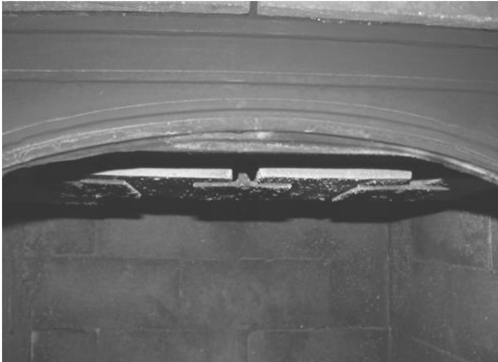
Schéma 3. Location des plaquettes réfractaires en relation avec la porte.
